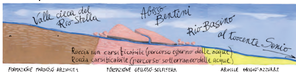
Sezione schematica del sistema carsico Stella-Basino (disegno T. Girani).
