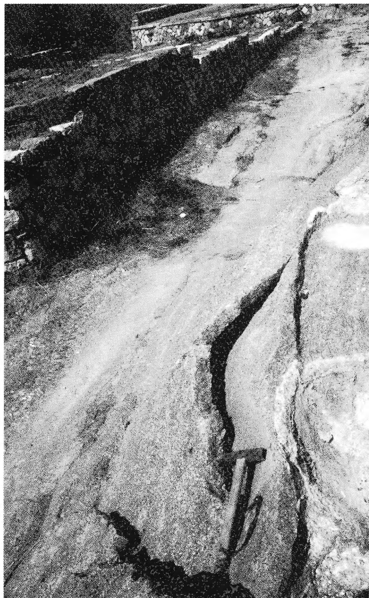
Fig. 2 - Le "bolle di scollamento" all'interno dell'antico abitato di Gessopalena edificato su uno sperone di gesso. "Décollement bubbles" inside the ancient town of Gessopalena, built on a gypsum spur.
