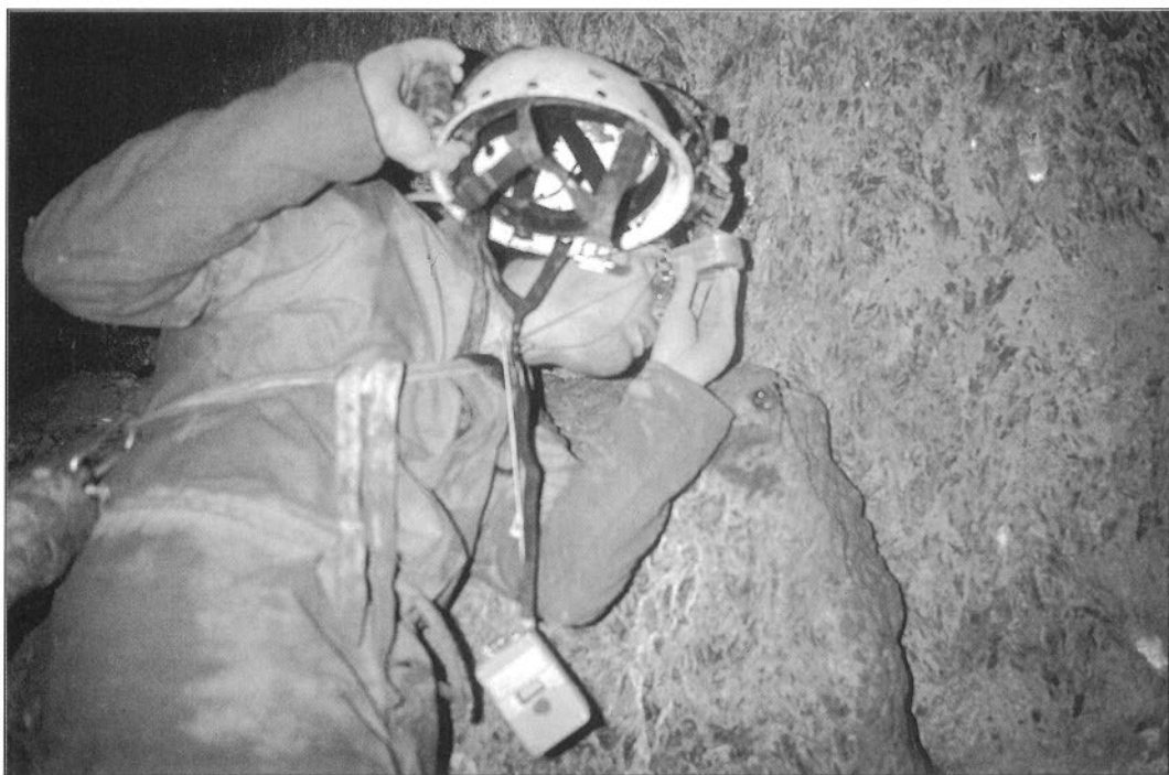
La lettura degli strumenti in grotta. Oltre ai classici "bussola e clinometro" l'uso di un longimetro elettronico agevola le misurazioni di lunghe tratte.
