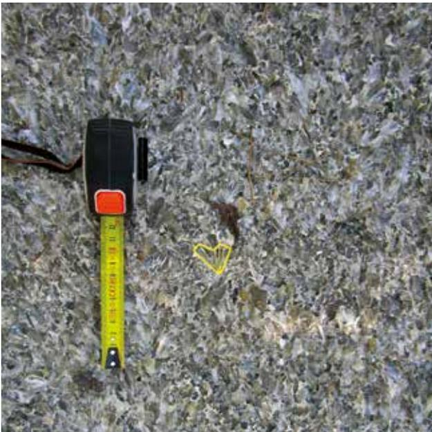
Fig. 5 – Cristalli gessosi di dimensioni centimetriche (per maggiore comprensione ne sono stati evidenziati alcuni, coi rispettivi piani di geminazione): si può apprezzare l'assoluta compattezza di questi intervalli evaporitici, dovuta alla fitta compenetrazione degli aggregati cristallini (sezione lungo il torr. Idice).
