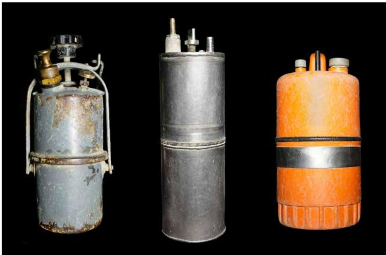
Da sx a dx: lampada a carburo AQUILAS - F.lli Santini - Ferrara Modello n° 7945, seconda metà del '900, modificata per uso speleologico con l'inserimento di una pompa; lampada a carburo costruita artigianalmente, per uso speleologico; lampada a carburo Alp Design - Fiorano - Al Serio (BG), 2005, antiurto e anticorrosione, con attacco a moschettone. Elevata autonomia, grazie al contenuto di 350 g di carburo.
