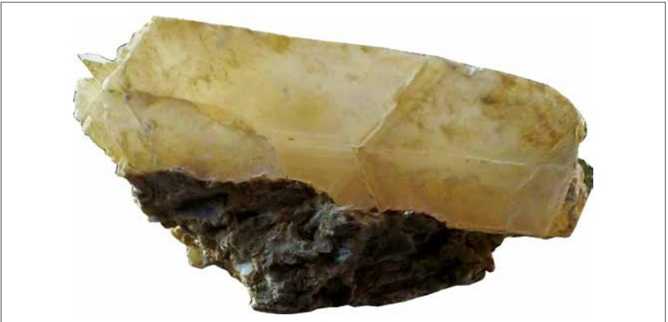
Fig. 31 – Un cristallo di lapis specularis, a contatto con la sua matrice di gesso selenitico. Questo particolare tipo di gesso secondario può essere facilmente lavorato, ricavandone lamine sottili e trasparenti, indicendolo lungo il principale piano di cristallizzazione.
