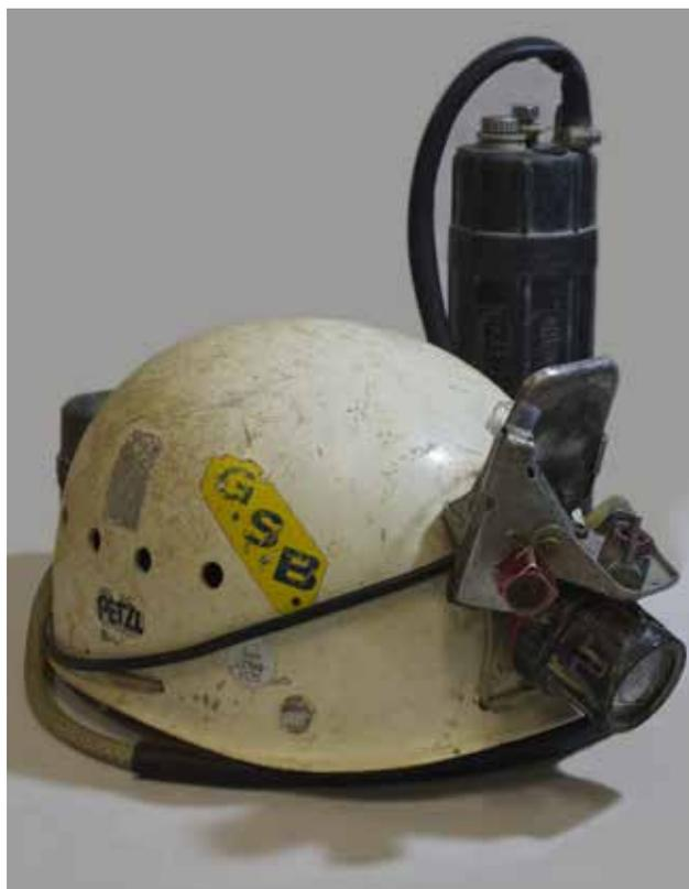
L'accoppiamento (autocostruito) lampada a carburo- casco con fotoforo elettrico.
