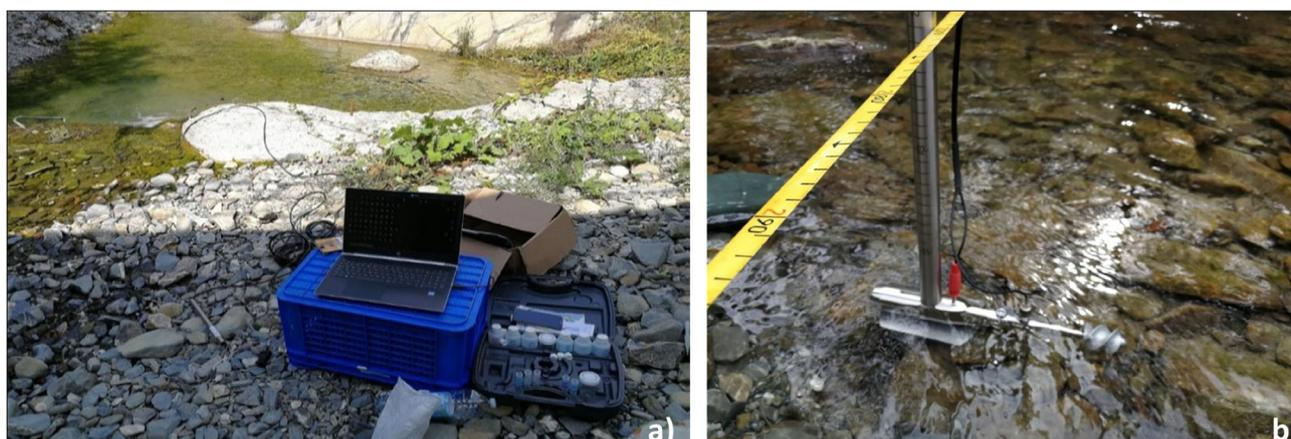
Figura 2 – Tecniche utilizzate per la misura della portata dei torrenti e delle Fonti di Poiano. a) tecnica del tracciante salino Q-pdt; b) tecnica del correntometro Q-cm.
