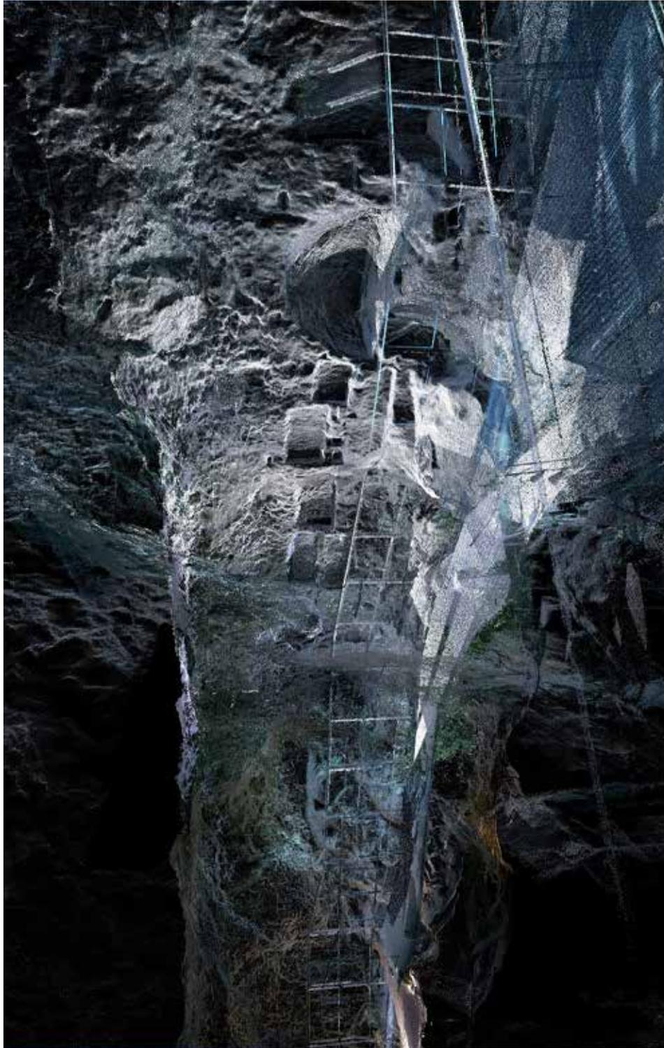
Rilievo effettuato con il laser scanner dell'ingresso della Grotta del Re Tiberio.
