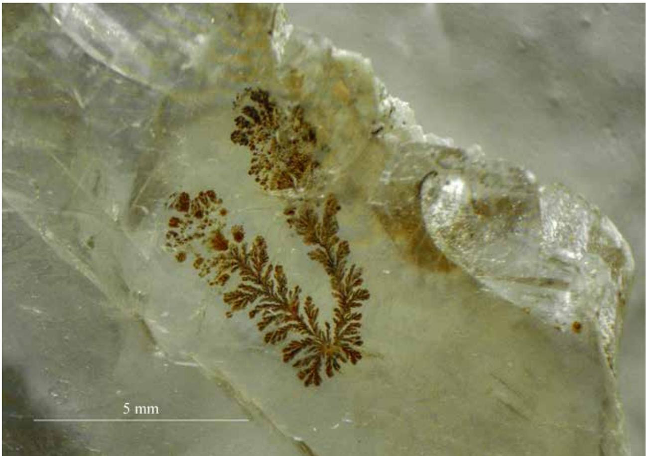
Fig. 2 – Frammento di gesso macrocristallino, campionato nella Grotta II nelle gallerie di cava di Monte Tondo, al cui interno si sono sviluppate delle dendriti di Fe e Mn lungo un piano di sfaldamento principale, che evidentemente si era leggermente divaricato per motivi tettonici o a causa del brillamento delle mine di cava (foto P. Lucci).
