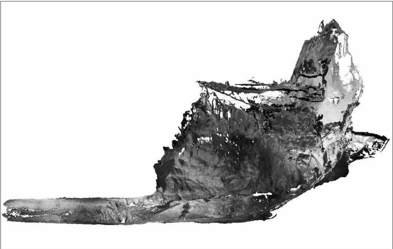
Fig. 2 – Rappresentazione di una sezione Nord-Sud della Sala Gotica ottenuta dal modello realizzato a partire dalla nuvola di punti.
