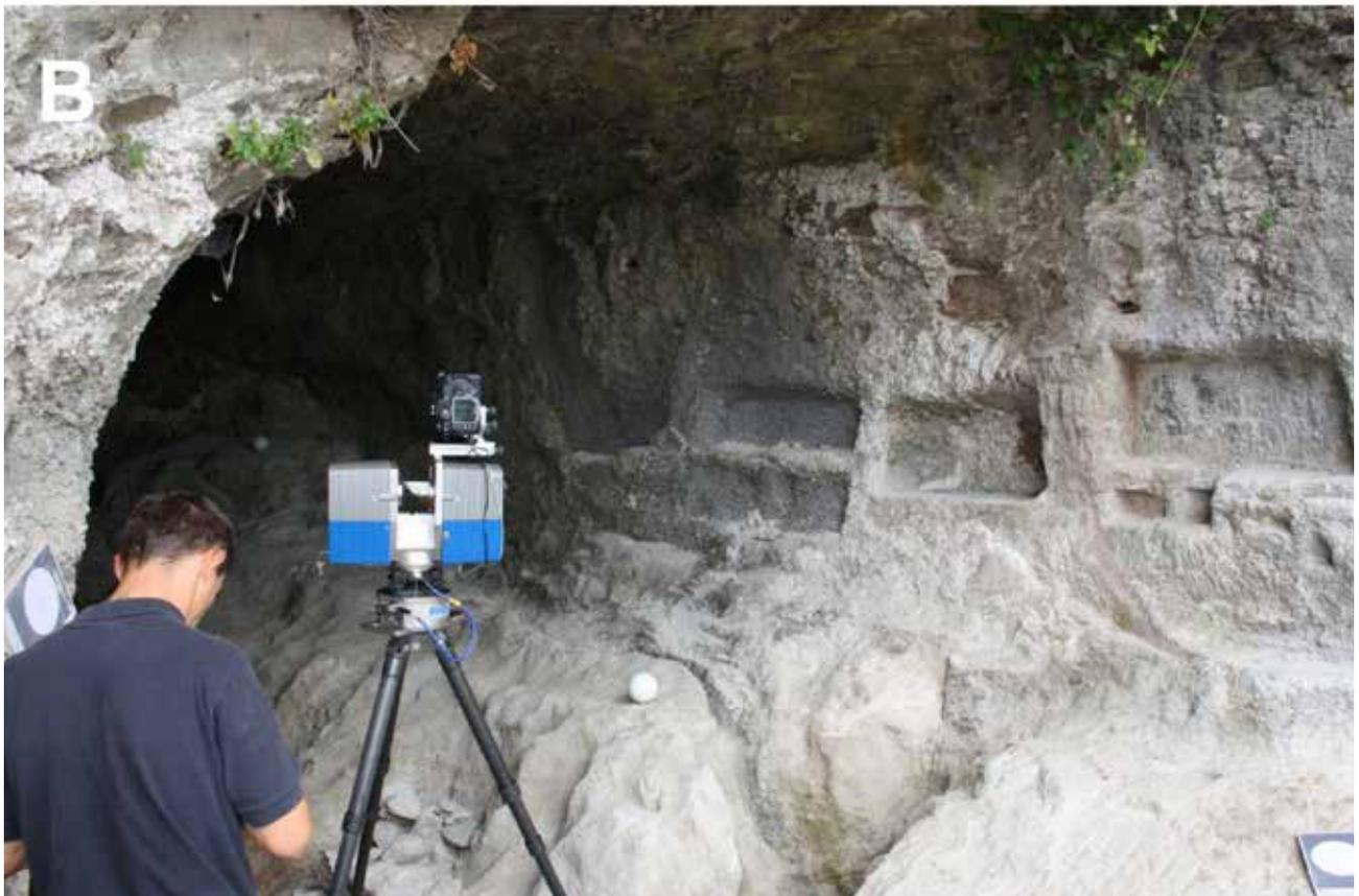
Fig. 1 – Grotta del Re Tiberio: A) in primo piano la “stazione totale” utilizzata per il rilievo cartografico della Grotta del Re Tiberio; B) il laser scanner modello FARO LS PHOTON 20-120 all’ingresso della Grotta del Re Tiberio (foto R. Tedeschi).
