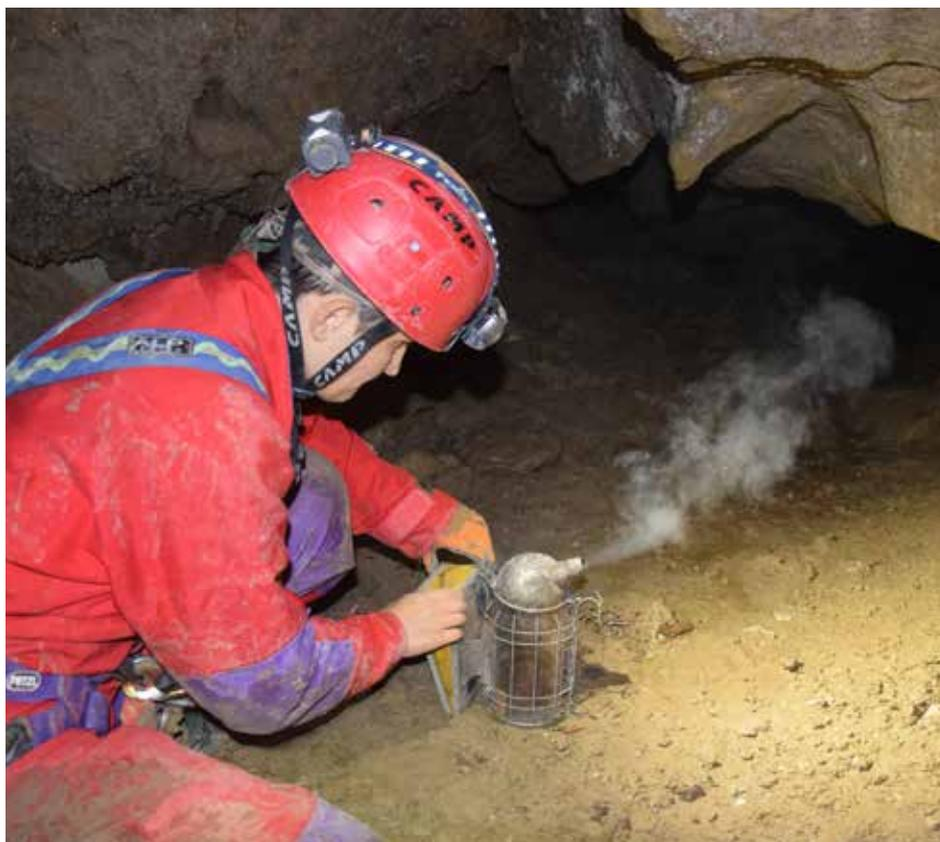
Fig. 34 – Tentativo di misura di flusso d'aria in ingresso presso l'Inghiottitoio a ovest di Ca' Siepe (ER RA 365), mediante misura della velocità di passaggio del fumo prodotto da affumicatore di alveari in una determinata sezione della grotta (foto S. Zauli).
