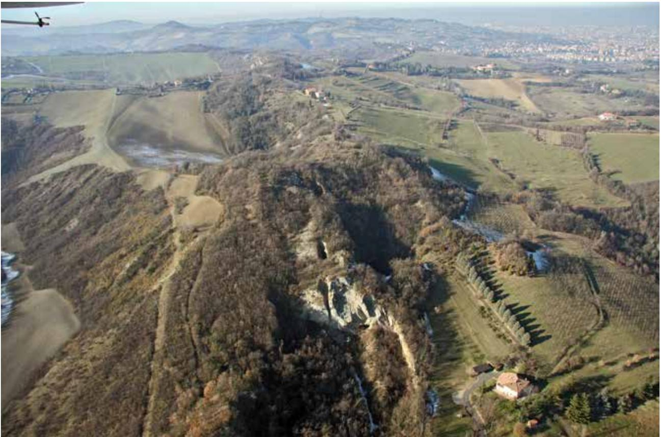
Fig. 2- La visione dei Gessi nella zona della località Farneto, in sx Zena: in primo piano le grandi fratture e l'enorme pozzo cui in superficie ha dato luogo il collasso di tratti delle gallerie della cava; sullo sfondo, a destra, l'area urbanizzata di Bologna. (Foto di Giovanni Bertolini)
