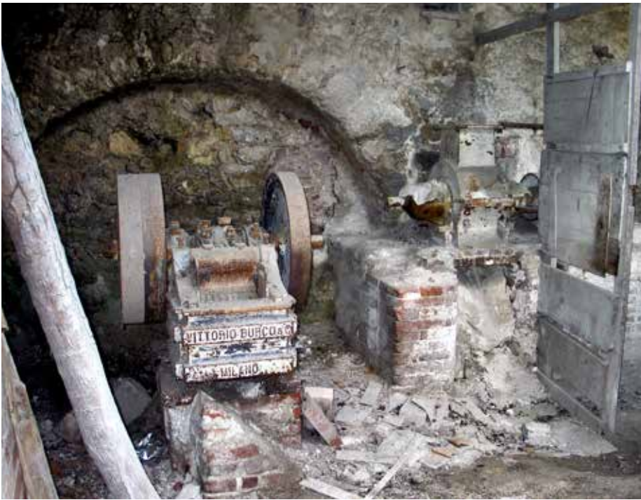
Fig. 2 (a sinistra) – L'interno della fornace Malpezzi precedentemente al restauro: si notano i macchinari per la frantumazione del gesso cotto (foto P. Lucci).
