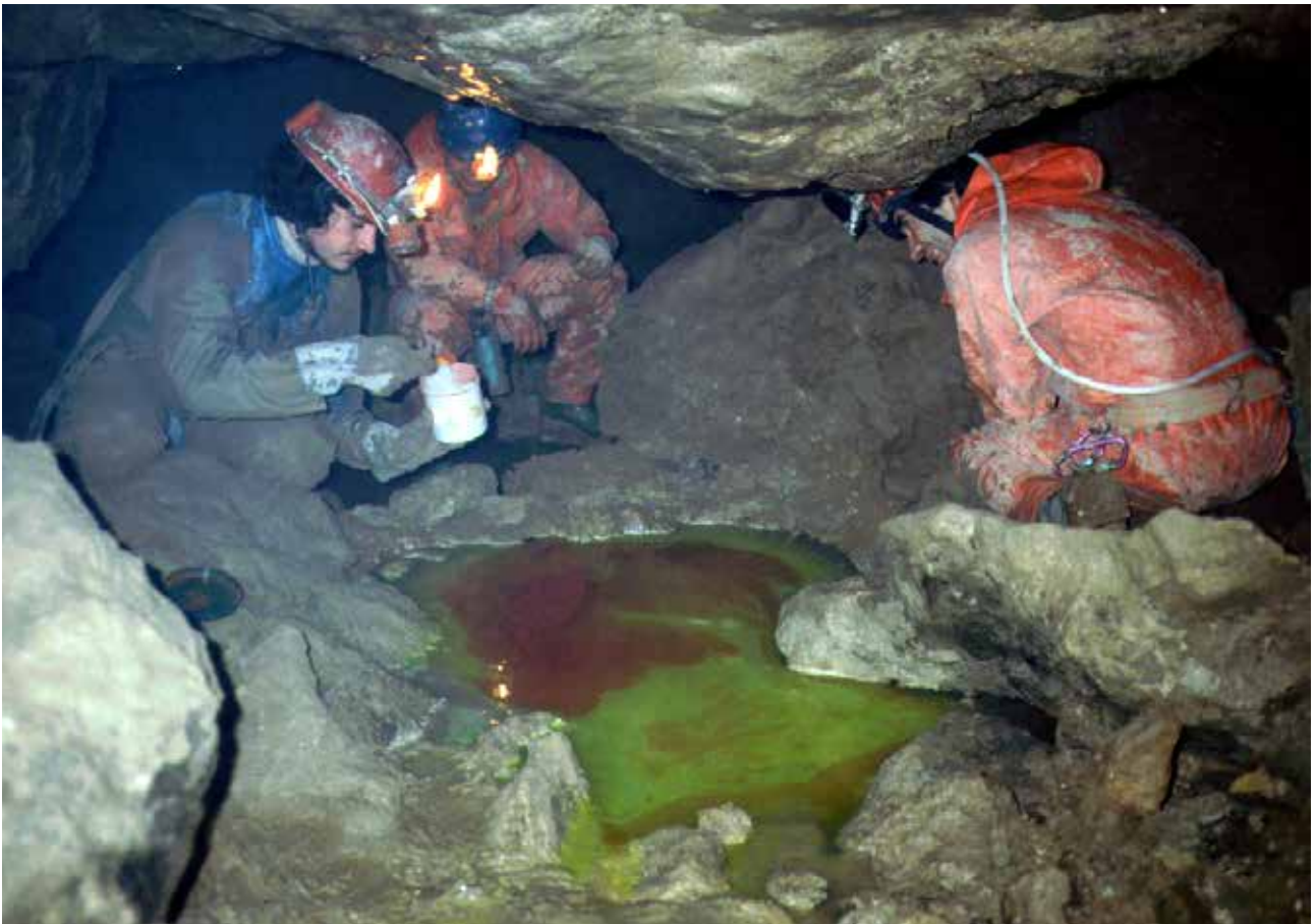
Fig. 17 (in basso) – Colorazione, tramite fluoresceina, delle acque dell'Abisso Luigi Fantini avvenuta nel corso del 1984. In questa prima colorazione i captori furono collocati solamente nella sorgente ubicata a nord delle Masiere, e diedero esito negativo. Due anni più tardi, fu eseguita una nuova colorazione, sempre partendo delle acque dello stesso abisso. Questa volta i captori, collocati nella Risorgente del Rio Cavinale, diedero esito positivo. Venne così definitivamente smentita la tesi di Mornig che voleva le acque dell'Abisso Fantini tornare a giorno appunto nei pressi delle Masiere. Nonostante, a seguito della colorazione, le acque assumano un evidenterissimo colore verde smeraldo va sottolineato che la fluoresceina, normalmente impiegata dagli speleologi, è una sostanza del tutto innocua. Da notare, infine, gli impianti di illuminazione ad acetilene che, fino a qualche anno fa, venivano universalmente impiegati in grotta. Oggi questi sono stati definitivamente sostituiti da impianti a LED, meno inquinanti, più pratici e razionali (foto Archivio Gruppo Speleologico Faentino).
