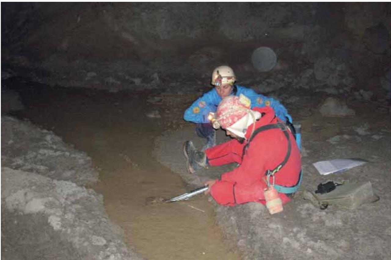
Fig. 17 – Misura dei parametri chimico-fisici mediante immersione in acqua corrente. Punto di misura M42 (emissario del sistema di drenaggio 1 a quota 200 m s.l.m.) (foto Archivio GYPROC Saint-Gobain; GHISELLI *et alii* 2008).
