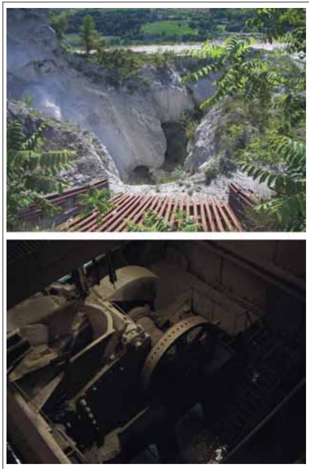
Fig. 15 – In alto: pozzo principale (via di gettito) accessibile a cielo aperto dalla quota di 260 m s.l.m. (foto R. Margutti). In basso: particolare del frantoio primario a mascelle (a doppia ginocchiera) con bocca 1200x1000 mm della Loro & Parigini (foto R. Margutti).
