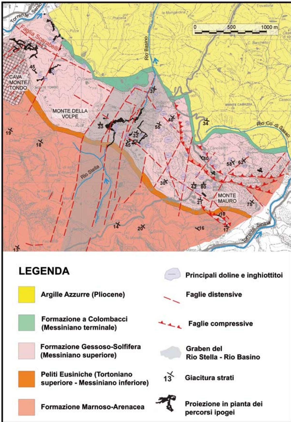
Fig. 7 - Carta geologica schematica da Monte della Volpe a Monte Mauro, con sovrapposizione degli elementi idrografici e speleologici principali (modificata dalla Carta Geologica d'Italia, Foglio 239 Faenza, 2009). Il semi-Graben Rio Stella-Rio Basino è marcato da retino leggero. I lembi terrazzati, detritici e franosi sono stati esclusi.
