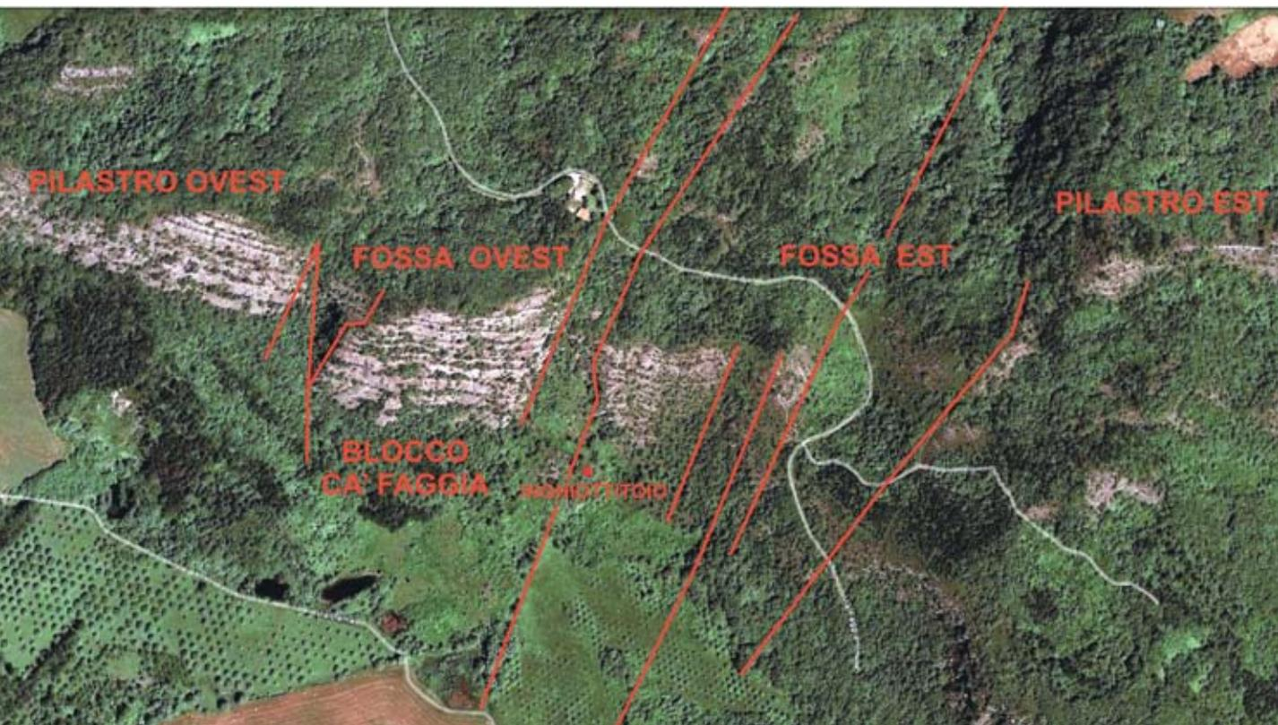
Fig. 3 - Immagine sintetica quasi zenitale della fossa del Rio Stella (da Google Earth 2009). Si noti la faglia marcatamente trascorrente destra che delimita a O il blocco di Ca' Faggia.
