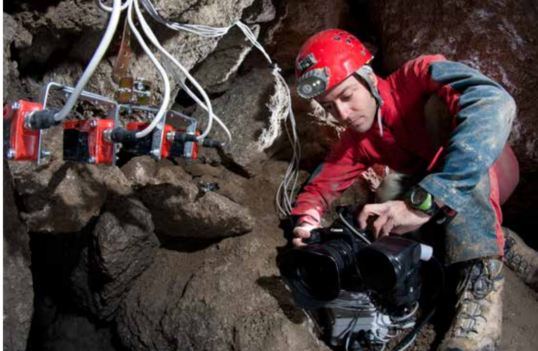
Installazione della fototrappola IR presso l'Inghiottitoio dell'Acquafredda (BO). Si notino la modularità della barriera fotoelettrica e la schermatura, con filtro IR a 840nm, del lampeggiatore.
