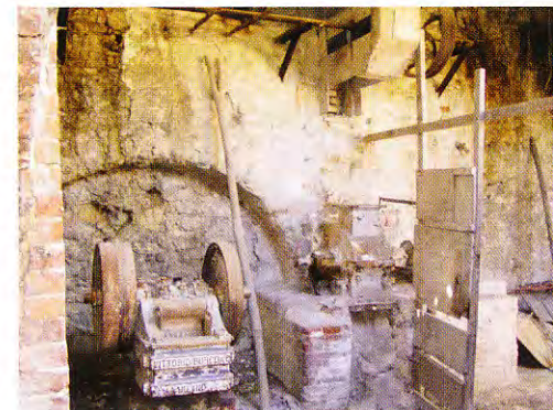
L'interno della fornace costruita verso la metà del XIX secolo dalla famiglia Malpezzi presso la rocca di Brisighella, oggi in stato di totale abbandono. Sono visibili macchinari per la frantumazione del gesso risalenti agli inizi del XX secolo (foto S. Piastra).
