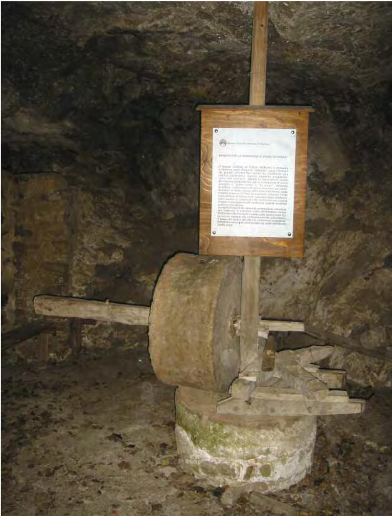
[4] Impianto di frantumazione del gesso, di Età contemporanea, ospitato in una piccola cavità nei pressi dell'inghiottitoio di Onferno (Rn).
