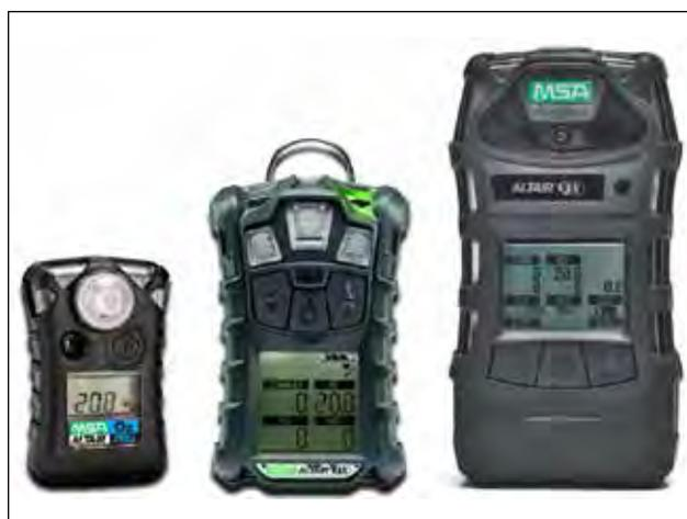
Fig. 18 – Misuratori di gas MSA, da sinistra Altair Pro, Altair 4x e Altair 5x.
