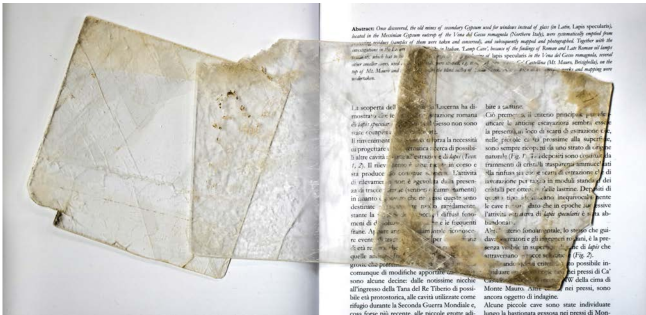
Fig. 2 – Lastrine di lapis specularis (spessore circa 1 mm) realizzate a imitazione delle originali di epoca romana, impiegate nella fabbricazione di pannelli per finestre (foto P. Lucci).
