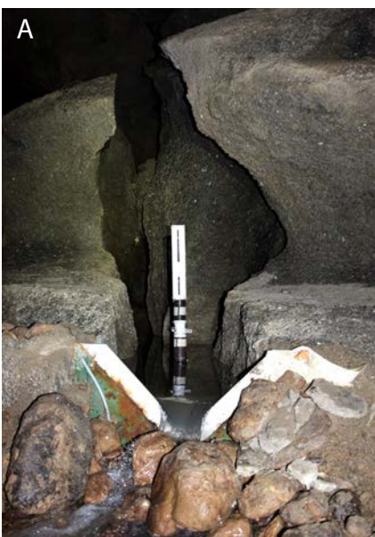
Fig. 11 – A-B-C) Idrometro per registrazione portata massima installato presso il punto di misura S2 (vedi fig. 12) (foto S. Zauli).
