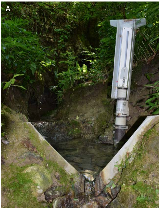
Fig. 32 – Stramazzo ubicato presso la Risorgente di SEMPAL: A) particolare in periodo di magra, foto effettuata in data 21/04/2017, portata rilevata allo stramazzo 0,75 l/s; B) in periodo di piena, foto effettuata in data 24/02/2018, portata rilevata allo stramazzo 45 l/s (foto S. Zauli).
