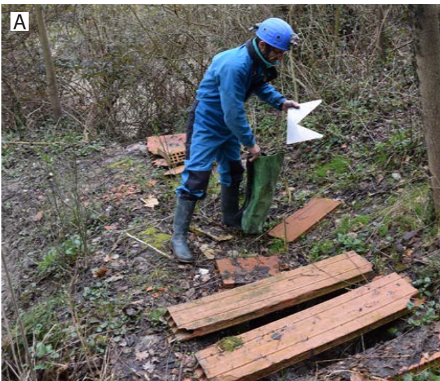
Fig. 10 – A) Stramazzo portatile utilizzato presso la Risorgente di Cassano (foto E. Sfrisi); B) lo stramazzo in opera (foto E. Sfrisi).
