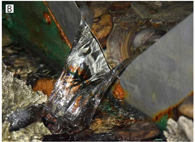
Fig. 9 – A) Stramazzo modello “Thomson + Bazin” installato presso il punto di misura S1 (fig.12) (foto S. Zauli); B) particolare del flusso sul profilo a V (foto E. Sfrisi).
