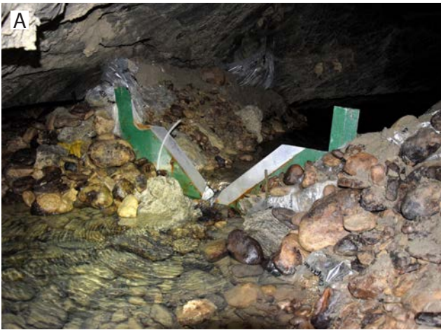
Fig. 9 – A) Stramazzo modello “Thomson + Bazin” installato presso il punto di misura S1 (fig.12) (foto S. Zauli); B) particolare del flusso sul profilo a V (foto E. Sfrisi).
