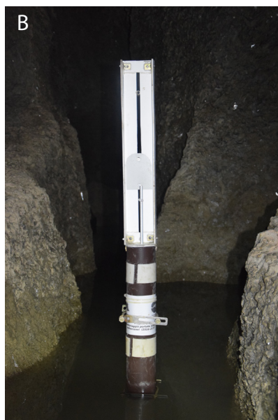
Fig. 11 – A-B-C) Idrometro per registrazione portata massima installato presso il punto di misura S2 (vedi fig. 12) (foto S. Zauli).
