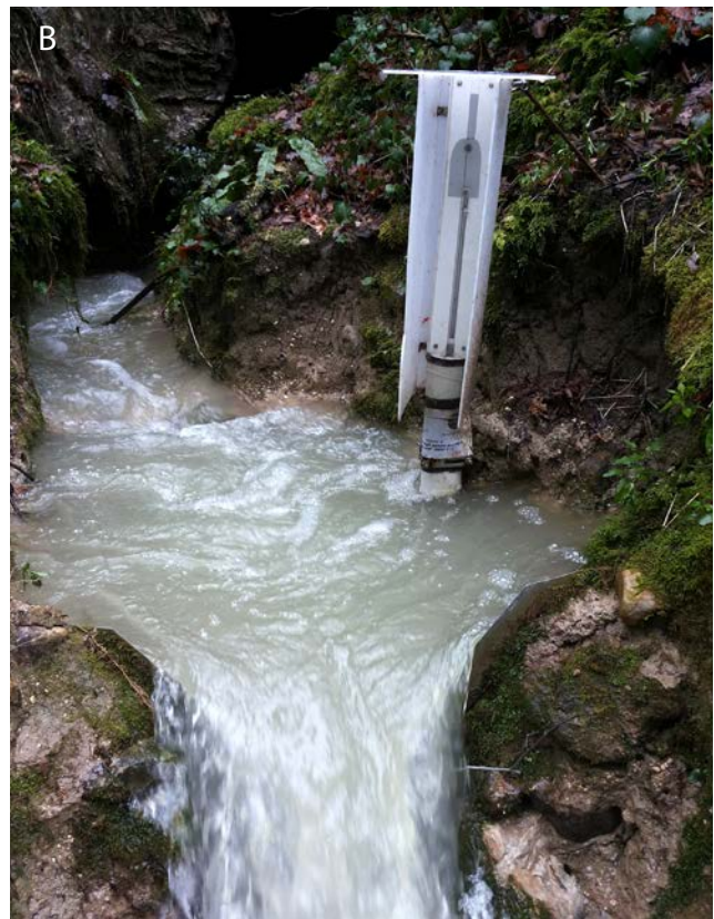
Fig. 32 – Stramazzo ubicato presso la Risorgente di SEMPAL: A) particolare in periodo di magra, foto effettuata in data 21/04/2017, portata rilevata allo stramazzo 0,75 l/s; B) in periodo di piena, foto effettuata in data 24/02/2018, portata rilevata allo stramazzo 45 l/s (foto S. Zauli).
