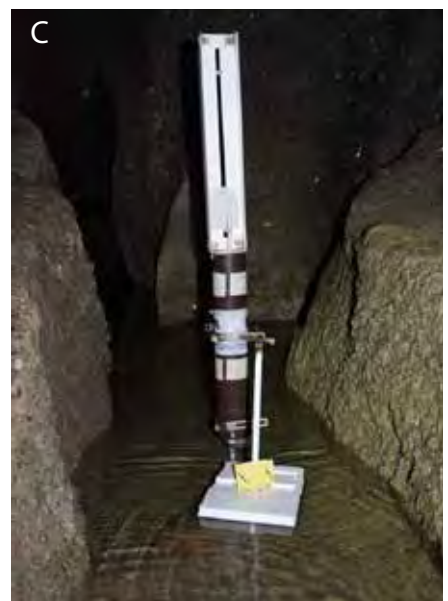
Fig. 11 – A-B-C) Idrometro per registrazione portata massima installato presso il punto di misura S2 (vedi fig. 12) (foto S. Zauli).
