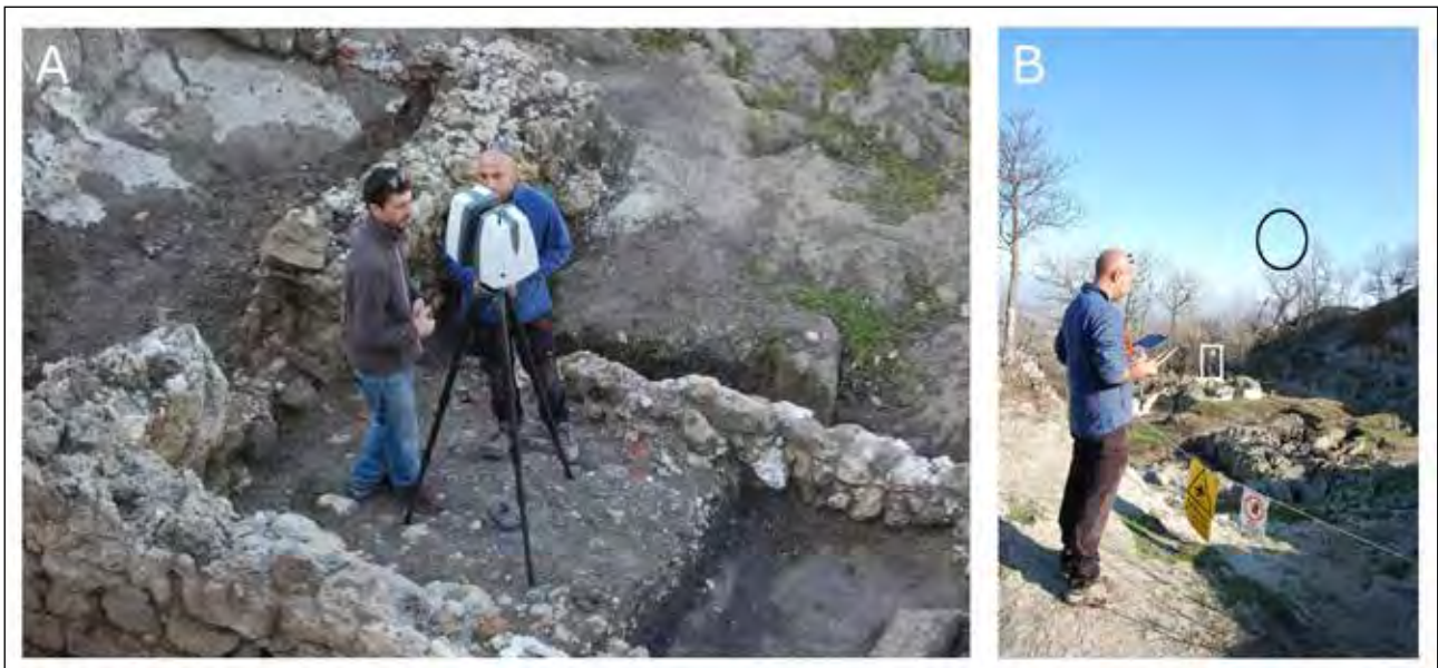
Fig. 3 – Il rilievo in campagna: A. il laser scanner Scan Station Leica P40 della VIGEA (Reggio Emilia); B. le fasi di rilevamento con il drone (nel cerchio). È visibile anche il laser scanner sullo sfondo (rettangolo).
