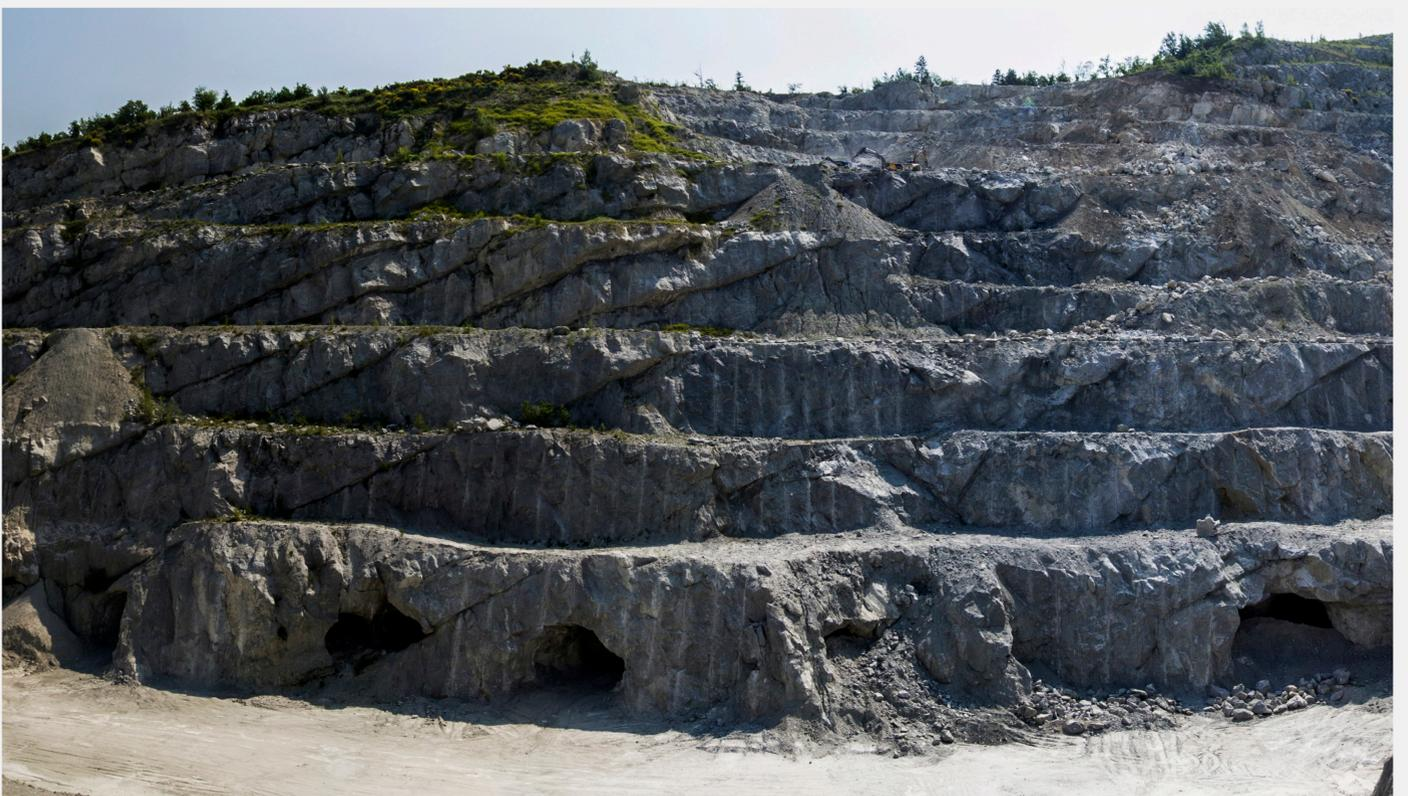
Segni di barramina nei gradoni della cava di Monte Tondo. Oggi si fa uso di macchine perforatrici, sempre in abbinamento all'impiego delle mine. Il segno lasciato sul gesso è simile: tracce verticali e parallele, ma testimonia una capacità distruttiva che non ha precedenti.
