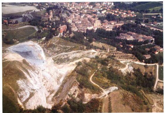
Fig. 20 – Vista aerea obliqua della cava fra il 1989 e il 1990. Si nota lo sperone dei due primi cicli (di colore grigio, al centro) e il terzo e quarto ciclo, più potenti (di colore biancastro, a sinistra).
