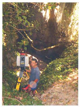
Fig. 2 – L'immagine mostra un momento del rilievo Laser Scanning in corrispondenza dell'inghiottitoio della Valle Cieca (foto I. Montanari).
