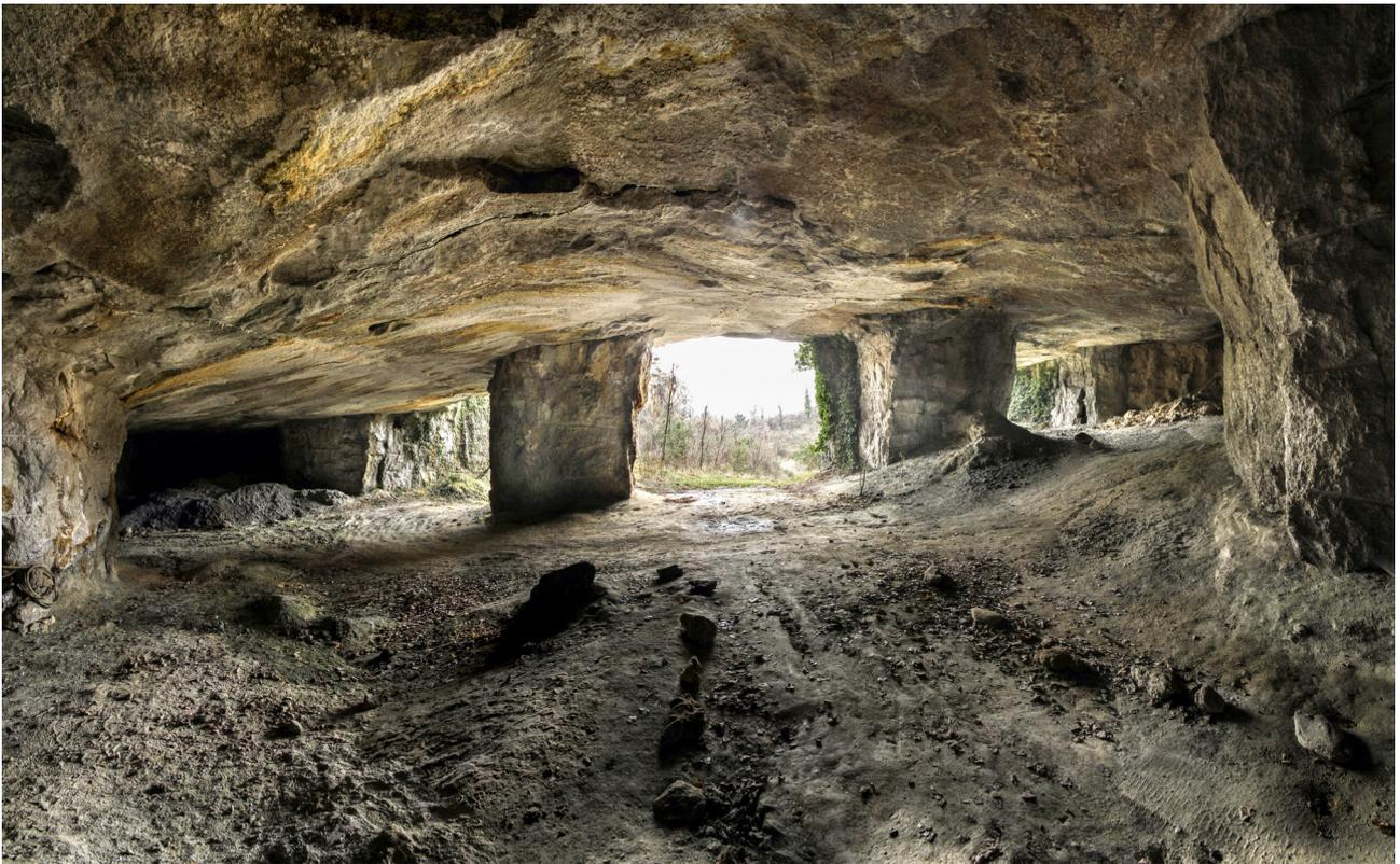
Fig. 11 – Le gallerie del lato nord-occidentale della cava Marana: prospettiva dall'interno verso l'esterno (foto P. Lucci). La coltivazione in sotterraneo, sviluppata su un solo livello, seguì qui il tradizionale metodo "camere e pilastri", demolendo un bancone gessoso.
