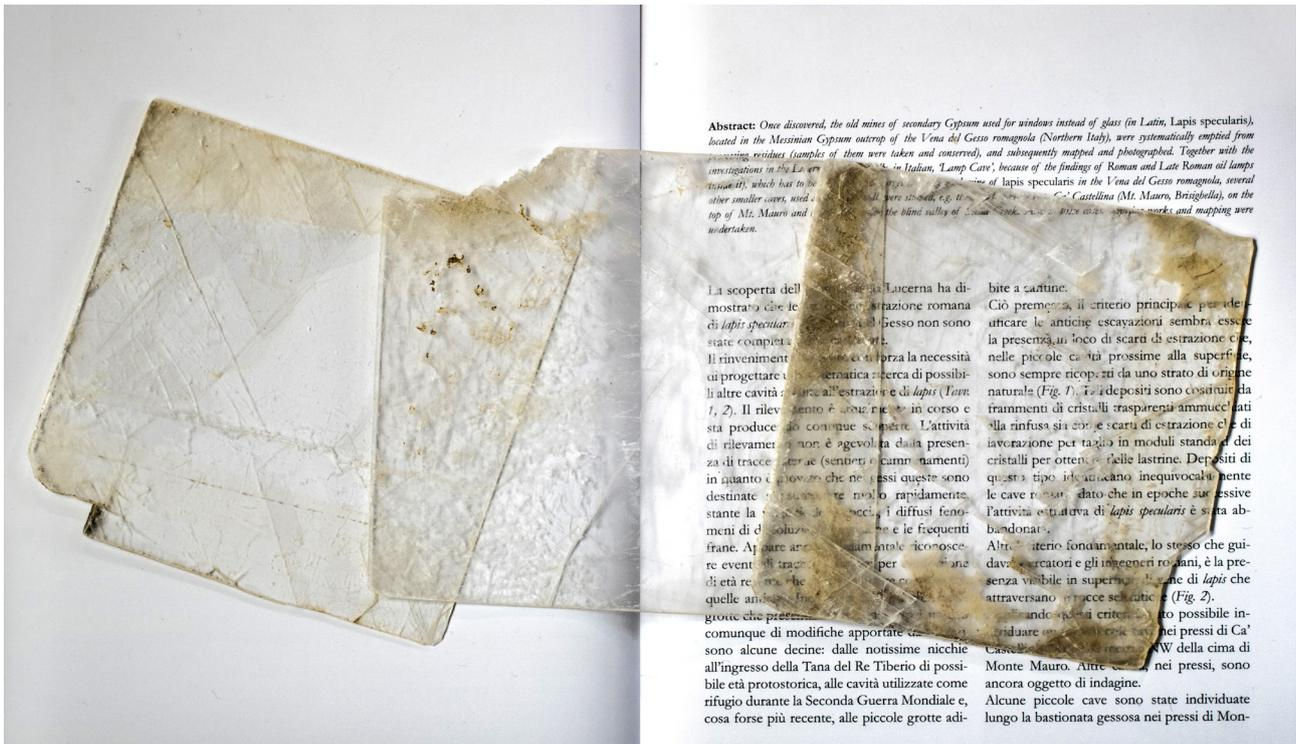
Fig. 13 – Lastrine di *lapis specularis* (spessore circa 1mm) realizzate ad imitazione delle originali di epoca romana (foto P. Lucci).
